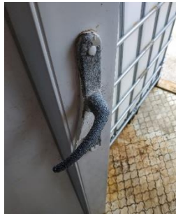
4. kép: Vegyi anyag kipárolgásának hatása egy fémkilincsen Forrás: szerző saját szerkesztése
